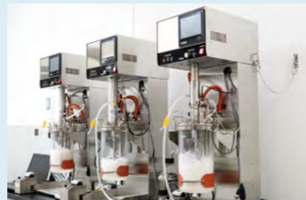
海洋生分解性樹脂であるポリヒドロキシ酪酸(PHB)培養の様子
